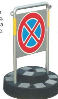
Dissuasore di sosta: o parapetonale, sarà sempre "all'altezza" della situazione, con l'archetto alto ben 80 cm non passa inosservato, pratico, sicuro, l'archetto viene fissato sotto alla zavorra con due viti, impedendone così lo sfilamento. Due occhielli sulla sommità possono accettare ganci e catene, la plancia misura 40 x 42 cm ed è personalizzabile con adesivi rifrangenti, ai lati possono essere applicati inserti rifrangenti
