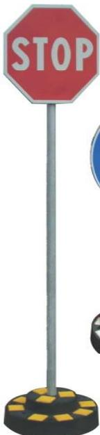
Zavor è realizzata in gomma riciclata e alloggia dei cubetti in cls che svolgono la doppia funzione estetica e di appesantimento, la base zavorrata pesa 45 kg. ben oltre la maggior parte di basamenti analoghi, inoltre per ulteriore sicurezza dispone di tre alloggiamenti per il fissaggio al suolo con tasselli ad espansione.
