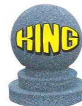
King, il primo dissuasore di sosta "over size", massiccio e visibile, prodotto con una miscela di elastomeri colorati risulta del tutto simile al granito e granitica è la sua stazza, misura, diametro base 600 mm altezza 700 mm peso 115 kg. ± 5%
