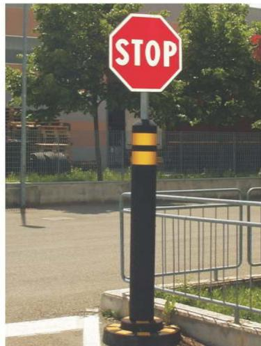
Attenuatore d'urto, specifico per sostegni segnaletici diametro 48 o 60 mm, si adatta anche su pali esistenti calzandolo dalla sommità. Trova collocazione in tutti quei casi dove i sostegni segnaletici possono costituire un pericolo soprattutto per cicli o motocicli, incroci pericolosi, rotonde, piste ciclabili, realizzato con gomma riciclata ha un'anima centrale in pvc, la sommità è dotata di due inserti rifrangenti. Le misure sono: diametro 200 mm; altezza 1750 mm, peso 35 kg.
